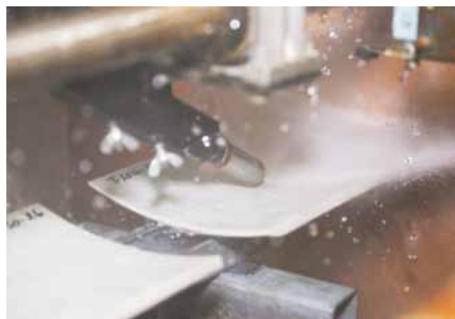
▲ Test della resistenza ai getti d'acqua presso il laboratorio di Flowtite Technology in Norvegia.
