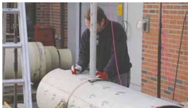
▲ Test della resistenza agli urti presso il laboratorio di Flowtite Technology in Norvegia.
