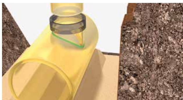
Obr. 3.8 | Inštalácia predĺženia kontrolného vstupu
