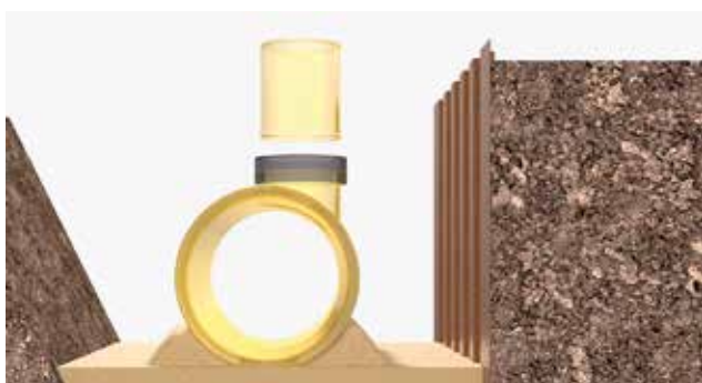
Obr. 3.7 | Inštalácia predĺženia kontrolného vstupu
