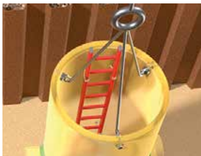
Obr. 2.3 | Zavesený kontrolný vstup šachty
