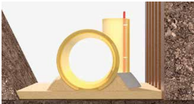
Obr. 3.5 | Betónová výplň pod stupňom
