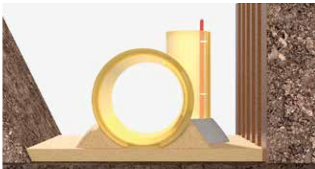
Рис. 3.5 | Бетонное наполнение под основанием
