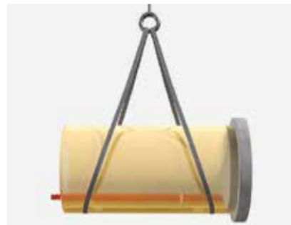
Photo 2.6 | Levage d'un regard horizontal avec deux sangles
