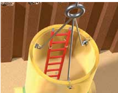
Photo 2.3 | Puits de regard, suspendu
