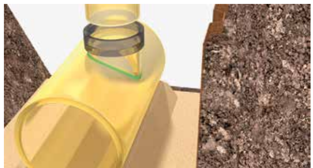
Photo 3.8 | Installation de l'extension d'entrée
