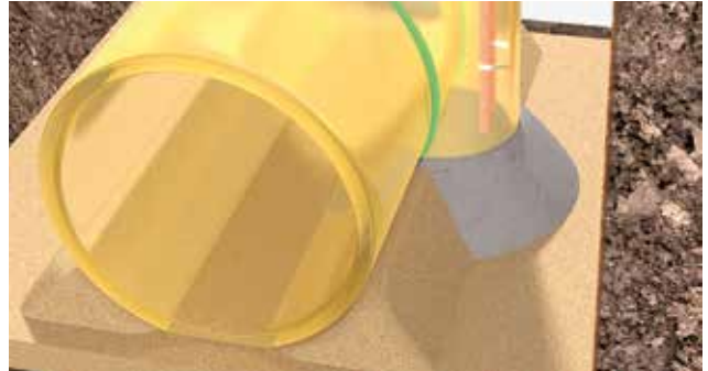
Obr. 3.6 | Betonová výplň pod nástupnicí
