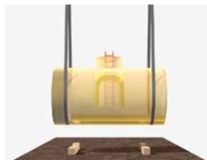
Obr. 2.7 | Zvedání koncového dílu dvěma popruhy
