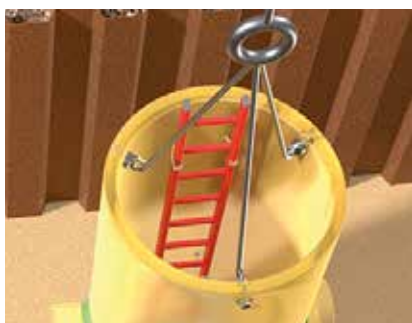
Obr. 2.3 | Zavěšený kontrolní vstup šachty
