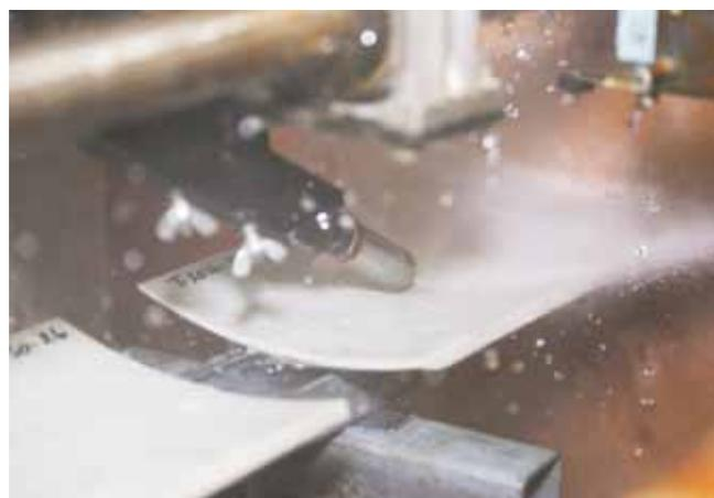
▲ Essai d'hydrocurage au laboratoire de Flowtite Technology en Norvège.
