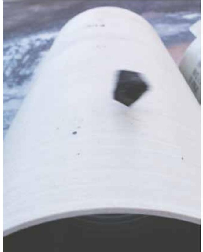
La résistance aux impacts désigne la capacité des tubes à résister aux impacts. La résistance aux impacts se mesure typiquement par une masse d'essai en chute libre sur des tubes vides et/ou remplis d'eau. Les tubes impactés sont ensuite inspectés afin de constater d'éventuels dommages et en outre, leur pression est testée afin de s'assurer de l'étanchéité à l'eau après l'impact.
