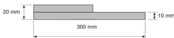
Rysunek 6-5 Konfiguracja opasek gumowych – Guma powinna mieć twardość 50 Shore'a
