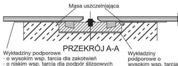
Rysunek 4-8 Kotwienie łączników w betonowych podporach
