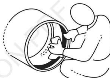
Rysunek 3-3 Smarowanie uszczelki
