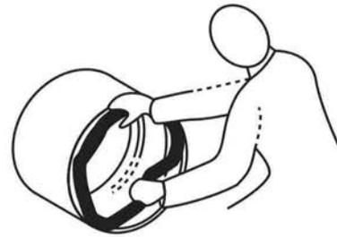
Figura 4.2 Instalación de las juntas
