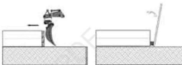
Figure 4-7 Montage avec godet de la pelle ou barre à mine
