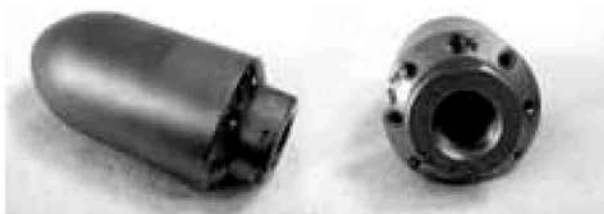
Figure J-1 Buse avec les orifices propulseurs autour de la circonférence d'un poids de 4,5 kg
