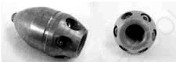
Figure J-2 Buse avec les orifices propulseurs autour de la circonférence d'un poids de 2,5kg.
